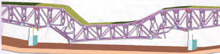
ELS Analysis Results of the I-35W Bridge Collapse
